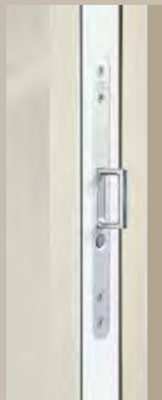
Kod kliznih vrata koja ulaze u zid, vratno krilo koje je potpuno gurnuto u zid možete pomoću skočne ručke, pritiskom na tipku, ponovo izvaditi i zatvoriti vrata.
